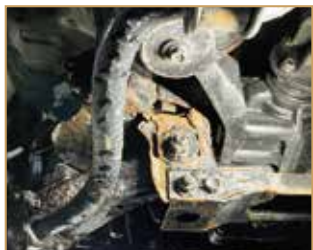
車体が錆びてしまった残念な事例
